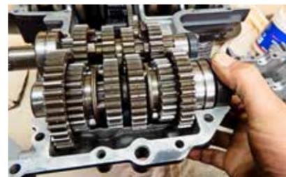
**STEP 9 FIT GEARBOX SHAFTS**
